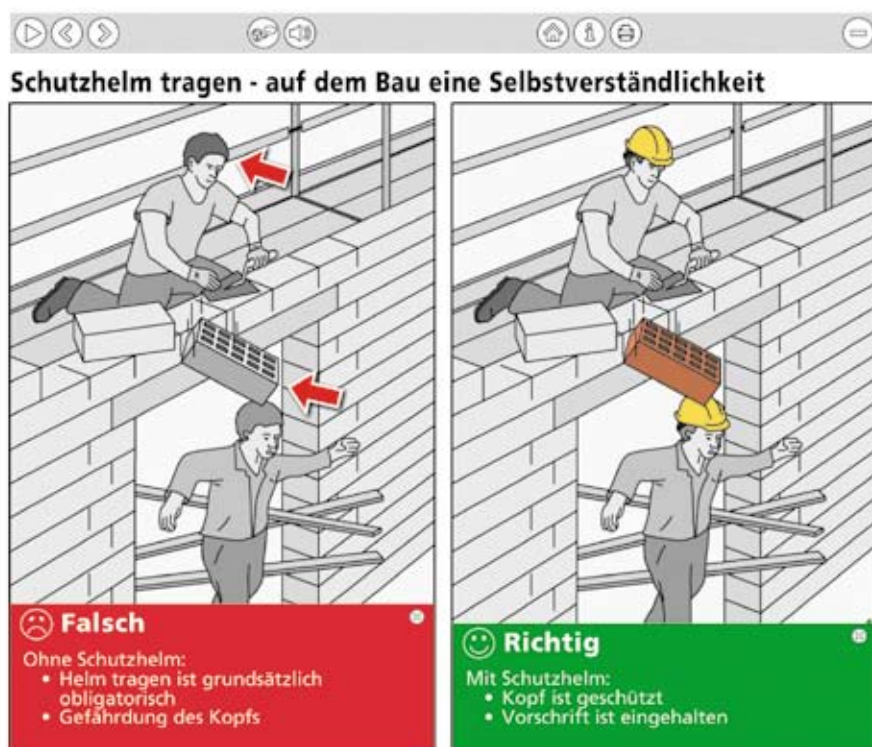
Beispiel von Gefahrensituationen: Falsch – richtig aus der neuen Präventions- Slideshow der Ekas.
