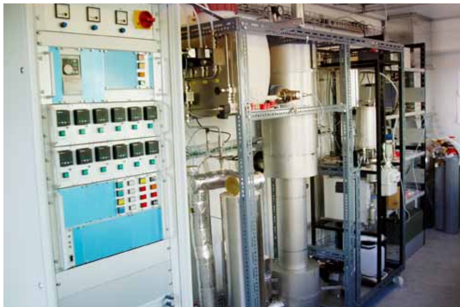
Durant le processus de méthanisation, qui se déroule dans des installations comme celles-ci, l'hydrogène réagit avec du CO 2 pour être transformé en méthane. Celui-ci est injecté dans le réseau de gaz naturel après avoir été dûment conditionné.
