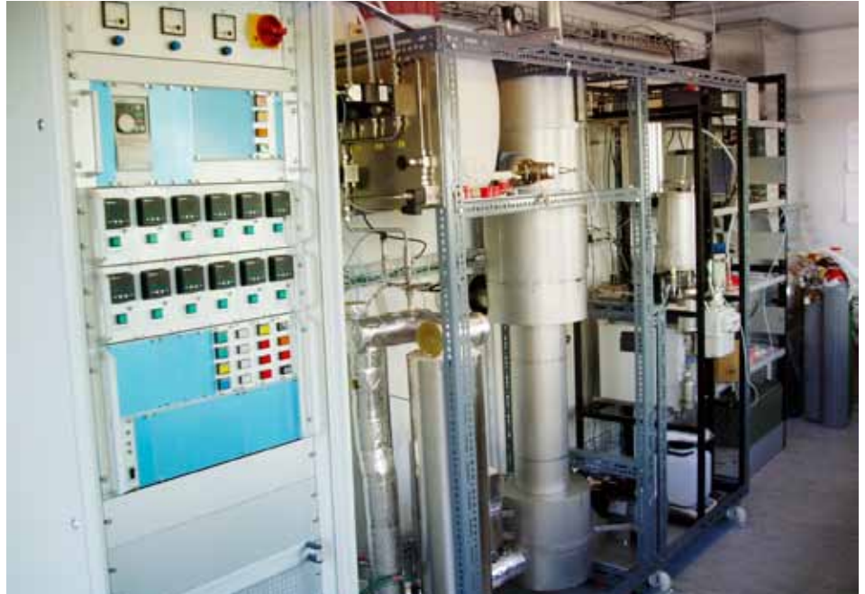
Im Prozess der Methanisierung, die in Anlagen wie der abgebildeten stattfindet, wird CO 2 mit Wasserstoff zu Methan umgesetzt, das nach geeigneter Konditionierung ins Erdgasnetz eingespeist werden kann.
